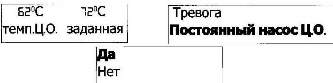
В этом режиме насосы начинают работу параллельно выше устаервленной температуры (смотри Функция включения насосов). Насос Ц.О. работает все время, а насос Г.Х.В. выключается после
