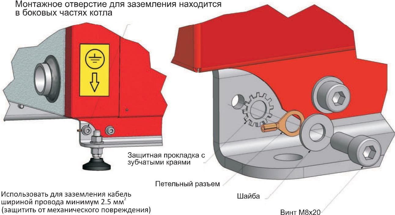
Использовать для заземления кабель шириной провода минимум 2.5 мм<sup>2</sup> (защитить от механического повреждения)
